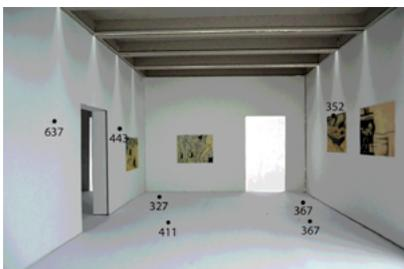
Fig.62. Simulation de l'éclairage artificiel situé entre les doubles poutres dans la Mirror-Box.
