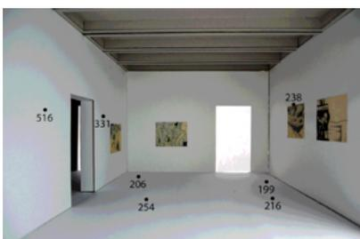
Fig.63. Relevé des valeurs d'éclairément (lx), dans la Mirror-Box.
