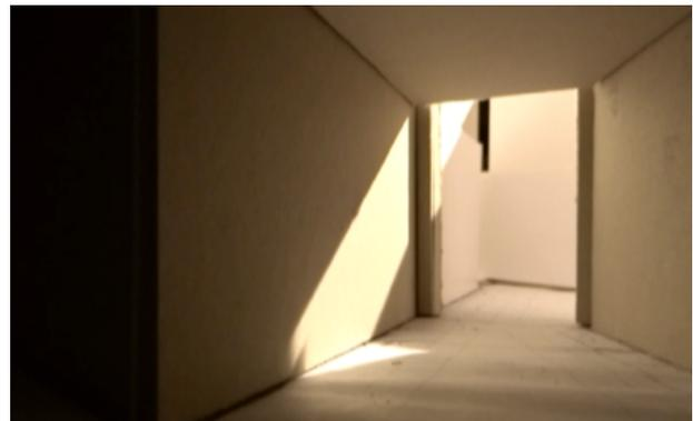
**Fig.35.** Pénétration des rayons solaires dans le hall souterrain. Fenêtre verticale et vide le long de la façade. 21 mars.
