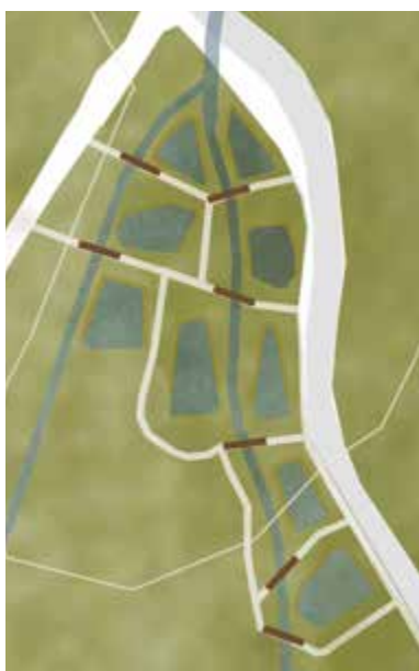
RÉSEAU DE BASSINS D'INFILTRATION
